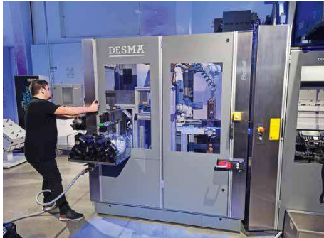
In kurzer Zeit abgekoppelt und wieder betriebsbereit: Die Flexcell von Desma wird mittels Luftkissensystem flexibel innerhalb der Halle manövriert. Foto: K-ZEITUNG/Bechlarz
