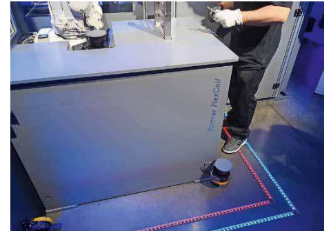
Roboter und Mitarbeiter arbeiten ohne Schutzzaun zusammen: Möglich macht dies ein neues, CE-konformes Sicherheitskonzept mit dreidimensionaler Scannerabsicherung. Foto: K-ZEITUNG/Bechlarz
