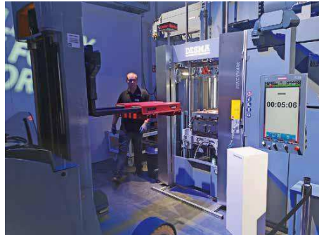
Quicklock in Aktion: Mit einer Transporteinrichtung kann das gesamte Werkzeug sicher über die Quicklock-Elemente mit einem Gabelstapler transportiert werden. Foto: K-ZEITUNG/Bechlarz
