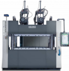
Auf der Desma 968.700 Sealmaster werden großformatige Batteriedichtungen hergestellt. Bild: Desma
