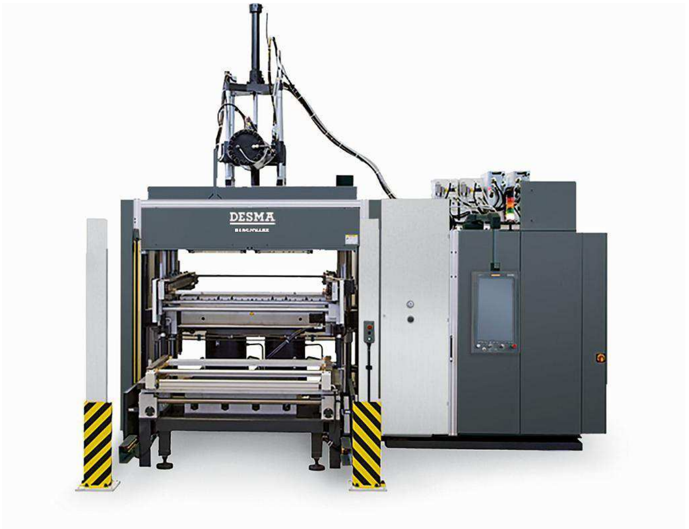
Die Spezialmaschine Desma TwinBenchmark kann bspw. zur Herstellung von Zylinderkopfdichtungen eingesetzt werden. (Foto: Desma)
